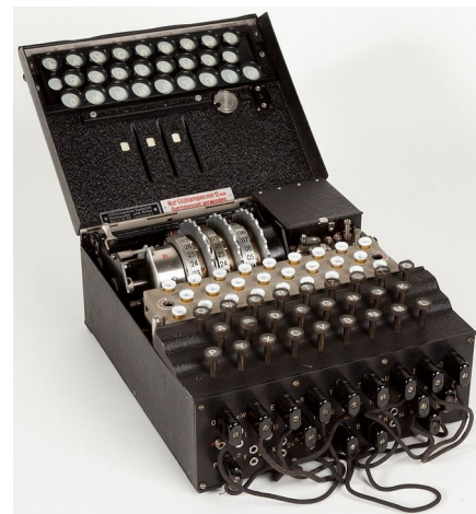
► Εικόνα 4: Πρωτότυπο ενός από τις πρώτες εκδόσεις της μηχανής Enigma, που χρησιμοποιήθηκαν κατά τη διάρκεια του Β' Παγκοσμίου Πολέμου από τους Γερμανούς για την κρυπτογράφηση τηλεγραφικών μηνυμάτων. (Πηγή: Wikipedia.org)
